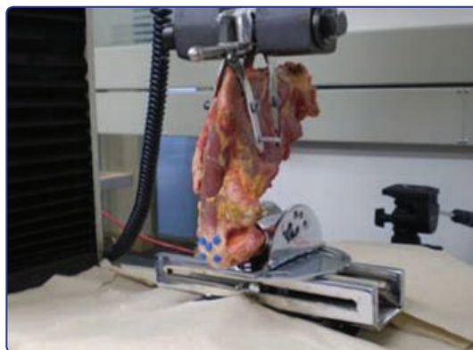
Figura 1. Complejo húmero-tendón-escápula en la máquina universal de ensayos.
